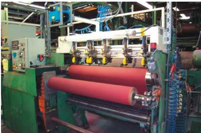
Ligne de fabrication pour les convoyeurs d'abrasifs
