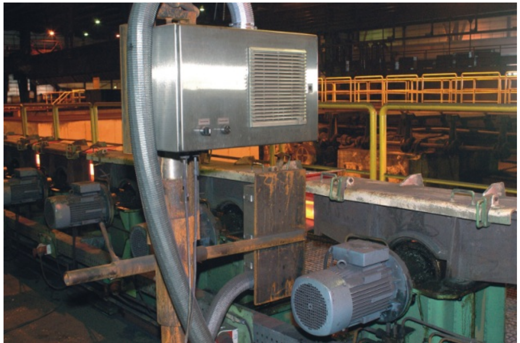
Mesure de vitesse sans contact sur ligne de laminage
