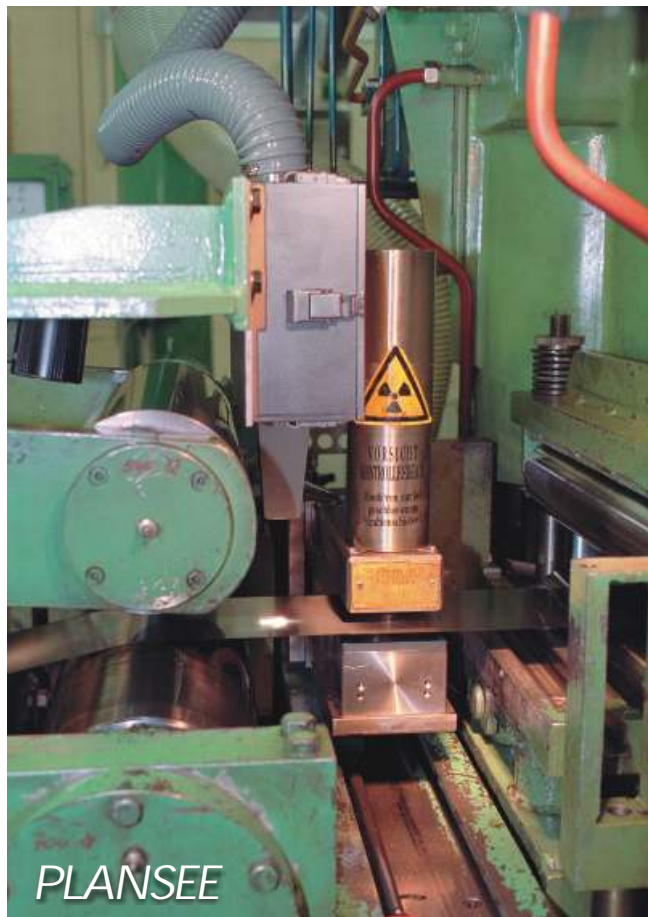
Appareil VLM 200 SD dans la cage à 20 rouleaux de SUNDWIG (côté gauche)
